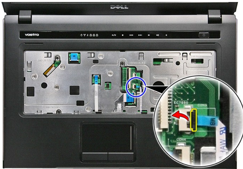
17. Irrota sormenjälkilukijan kaapeli emolevyn liittimestä.
